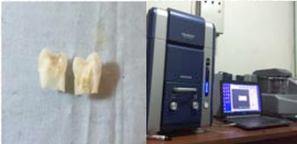
Gambar 5.1.2 (Kiri) Sampel dibelah secara longitudinal dari tengah tumpatan. (Kanan) Pengamatan Sampel menggunakan Scanning Electron Micrograph .
