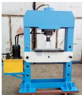
Gambar 4.13 Mesin *press* hidrolis
