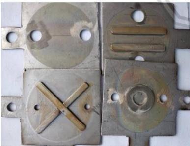
Gambar 4.7 Terdapat  $\text{Na}^+$  pada pelat elektroda
