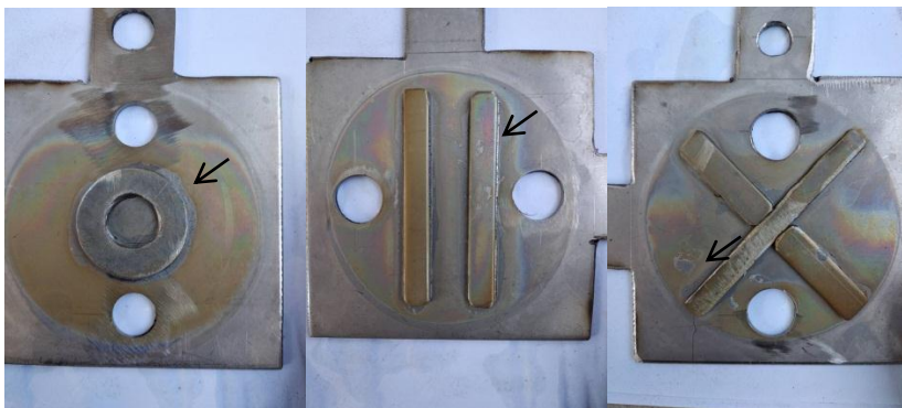
Gambar 4.8 Bekas pengeleman yang menghalangi proses elektrolisis
