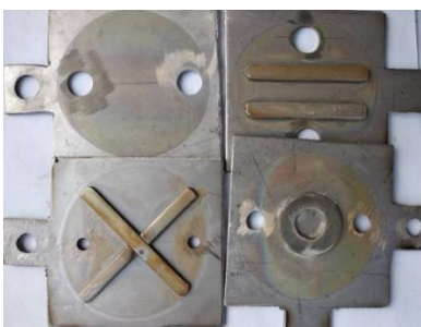
Gambar 4.7 Terdapat \text{Na}^+ pada pelat elektroda
