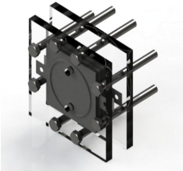
Gambar 3.2 Assembly bagian-bagian penyusun generator HHO
