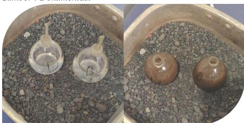
Gambar 4.2 Pendidihan labu ukur air dan labu ukur air + tanah
