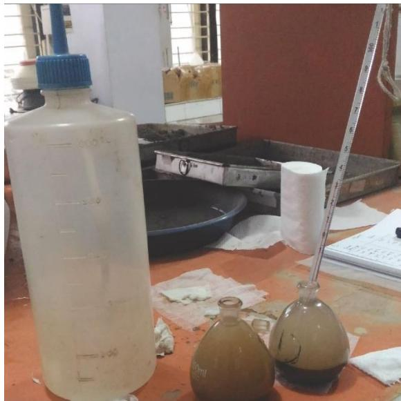
*Gambar 4.3 Pengukuran suhu labu ukur B dan labu ukur D*
