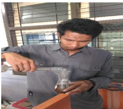
Gambar 4.4 Pencampuran larutan NaOH dengan sampel tanah
