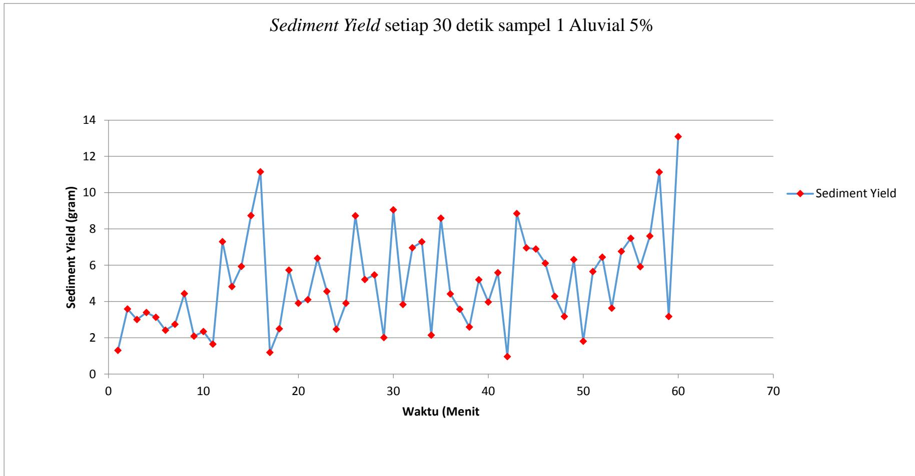
Gambar 4.19 Sediment Yield setiap 30 detik sampel grumosol percobaan 1
