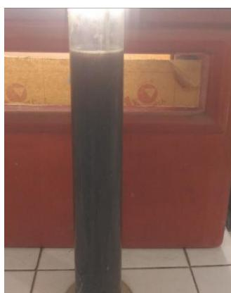
Gambar 4.6 Tabung hidrometer
