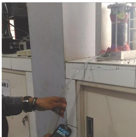
*Gambar 4.10 Pengukuran debit permeabilitas*
