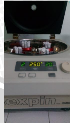
campuran disentrifugasi sehingga kolesterol dan endapan terpisah
