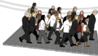
Gambar 2.16 Kondisi Pedestrian Tingkat Pelayanan LOS F
