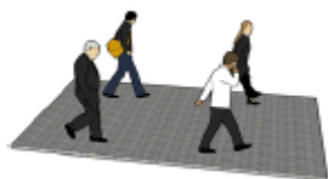
Gambar 2.14 Kondisi Pedestrian Tingkat Pelayanan LOS D
