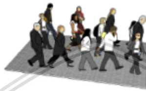
Gambar 2.15 Kondisi Pedestrian Tingkat Pelayanan LOS E
