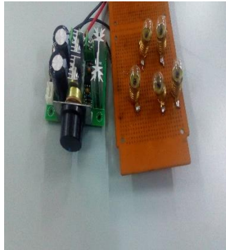
Gambar 3.13 Rangkaian beban resistif
