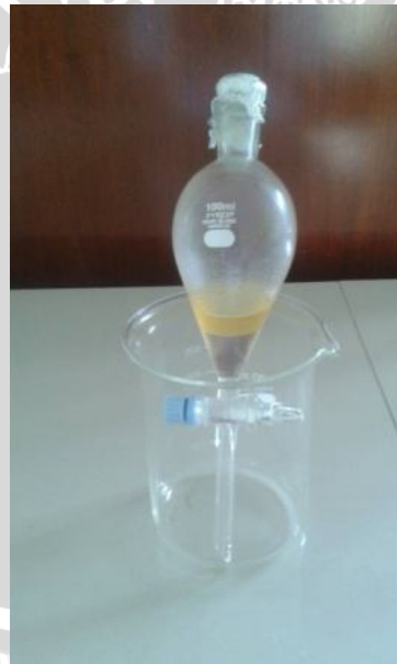
Ekstraksi Aliquat-336-Cl dengan larutan Tiosianat
