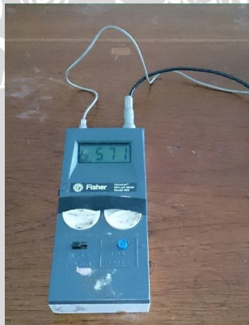
Pembacaan Potensial Pada Potensiometer
