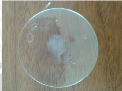
Penetesan Pb nitrat 1% untuk Mengetahui Ada Tidaknya \text{Cl}^-
