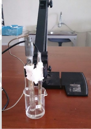
Pencelupan Elektroda Pembanding dan Indikator Ke Dalam Larutan Kerja Tiosianat
