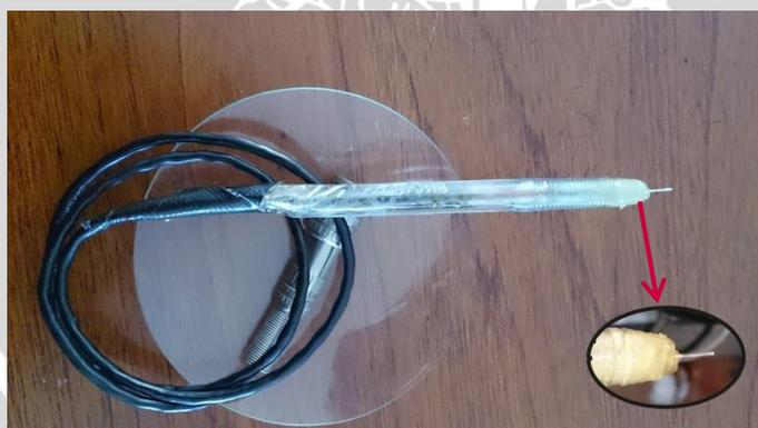
**Gambar 5.1** Membran sensor potensiometri tiosianat
