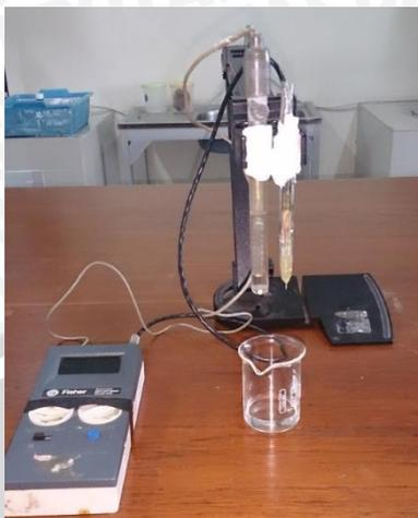
**Gambar 5.2** Pengukuran sensor potensiometri tiosianat pada larutan kerja  $\text{NH}_4\text{SCN}$
