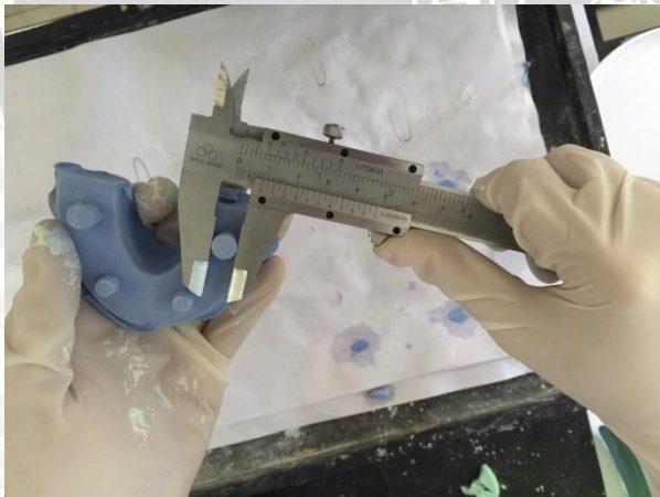
Pengukuran diameter silinder menggunakan kaliper
