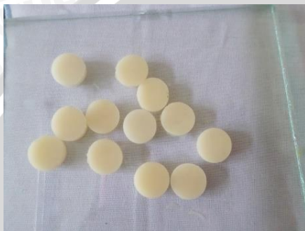
4.2.5 Sampel resin komposit nanohybrid
