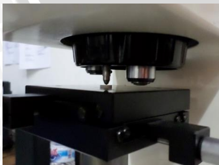
4.2.9 Pengukuran kekerasan permukaan dengan Digital Micro Vickers Hardness Tester
