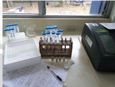
3.18 Pengukuran absorbansi saliva sesudah inkubasi 18-24 jam dengan spektrofotometer
