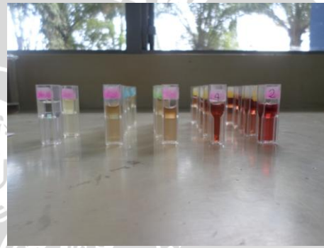
3.21 Sampel sesudah diukur dengan spektrofotometer
