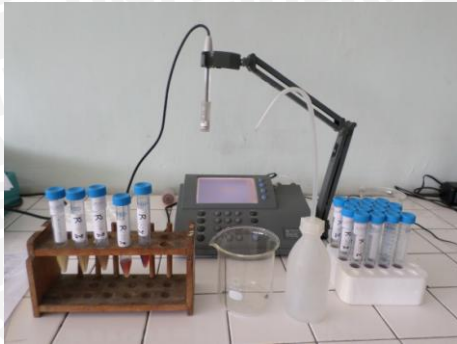
3.17 Pengukuran pH saliva sesudah inkubasi 18-24 jam dengan pH indikator
