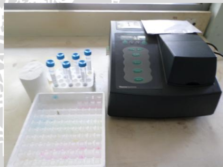
3.14 Pengukuran absorbansi saliva sesudah inkubasi 18-24 jam dengan spektrofotometer
