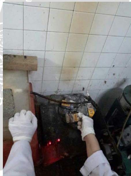
Pengasapan Rokok dengan Smoking Pump di Lab. Farmakologi FKUB
