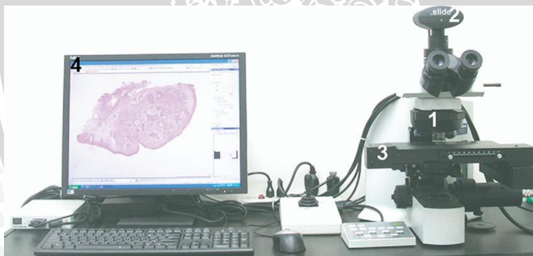
Gambar 2.3. Hardware yang digunakan dalam dot-slide system scan Olyvia (Chen et al , 2008)
