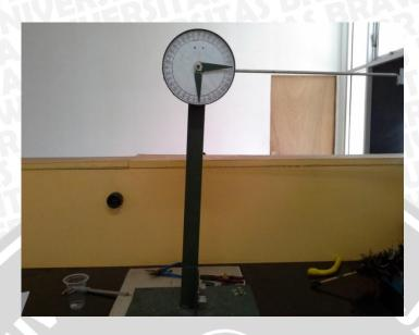
Gambar 4.8 Alat Uji Kekuatan Impak Charpy Test
