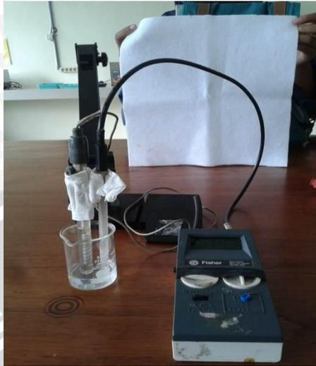
**Gambar 5.2** Rangkaian ESI pada proses pengukuran
