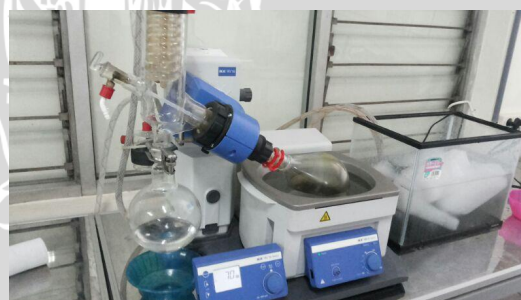
Proses Ekstraksi dengan metode maserasi dan pelarut diuapkan menggunakan Rotary Evaporator
