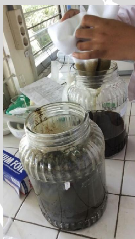
Proses Ekstraksi dengan metode maserasi dan pelarut diuapkan menggunakan Rotary Evaporator
