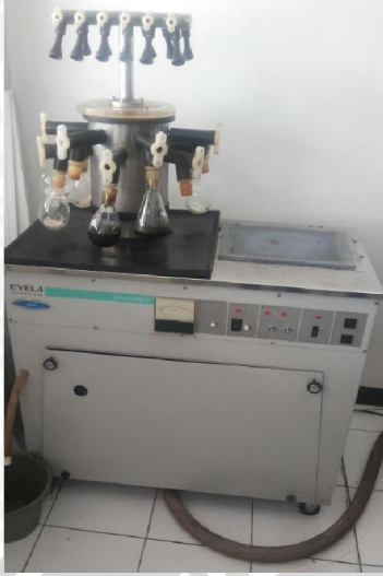
Proses pengeringan ekstrak dengan metode Freeze Drying
