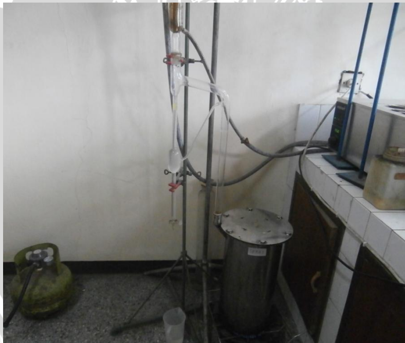
Gambar 4. Proses Distilasi Uap Serai Dapur ±4 jam
