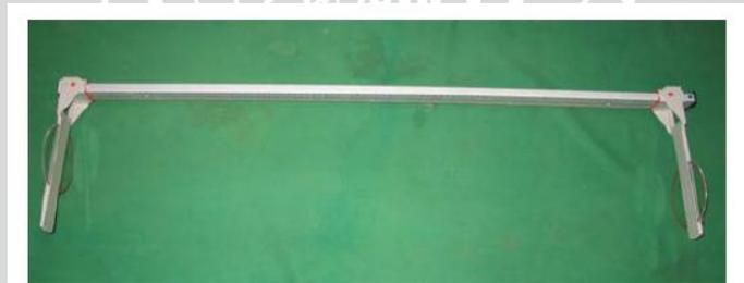
Gambar 4.2 Alat pengukur panjang badan dari alumunium
