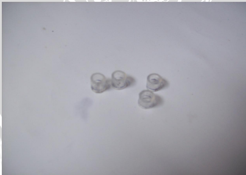
Gambar 4. Alat Cetak Sampel dari Disposable Syringe dengan t=6mm; Ø=5mm
