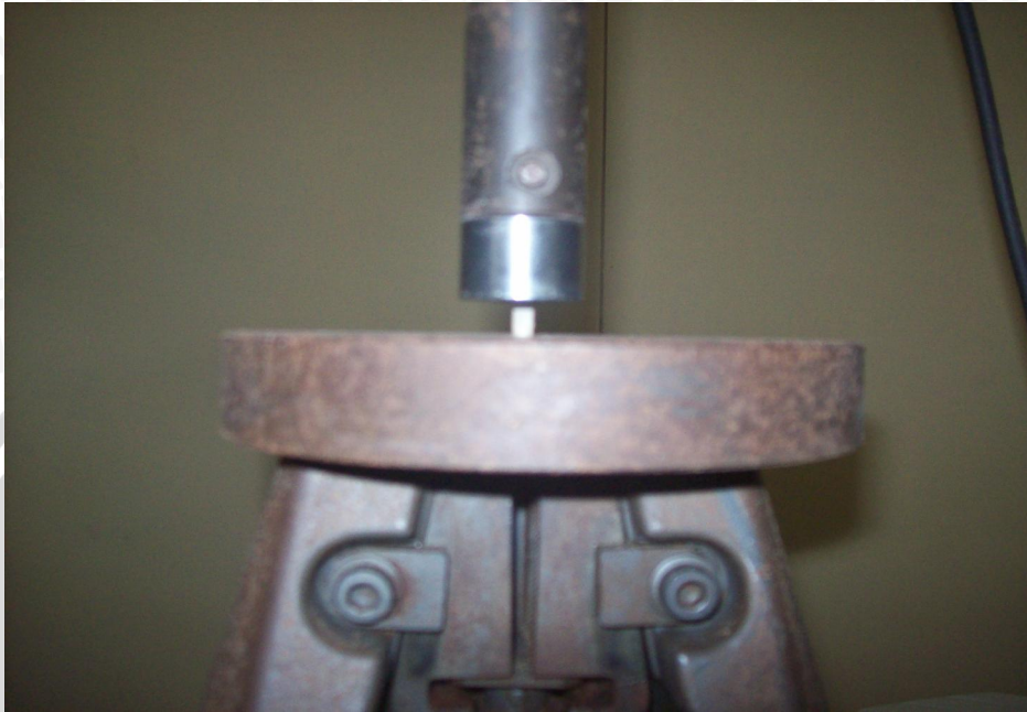
Gambar 8. Cross Head Berada pada Permukaan Sampel pada Saat Pengukuran Compressive Strength
