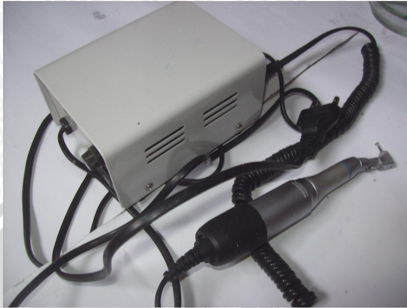
Gambar 3. Mikromotor dan Handpiece Contra Angle dengan Mata Bur Wheel
