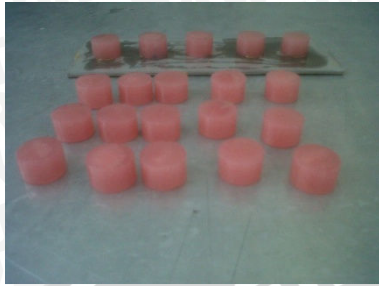
Gambar 1 (a) Silinder Berbahan Polimetil Metakrilat (Akrilik); (b) Sendok Cetak (Tray)
