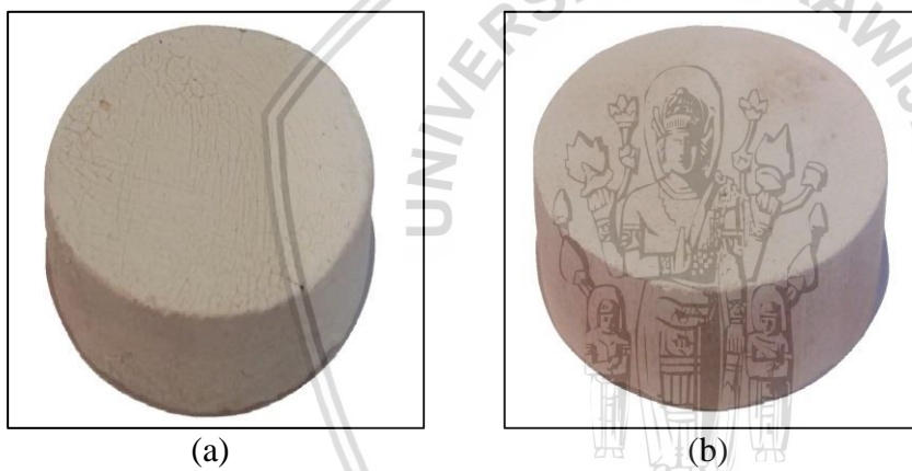
Gambar 4.8 Spesimen uji pembakaran tunggal (a) Dengan glasir dan (b) Tanpa glasir
