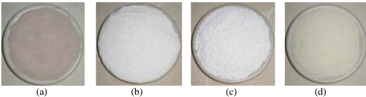
Gambar 2.1 Bahan baku utama (a) Ballclay , (b) Kaolin , (c) Silica , dan (d) Feldspar Sumber: Budiyanto (2008, p. 131-134)
