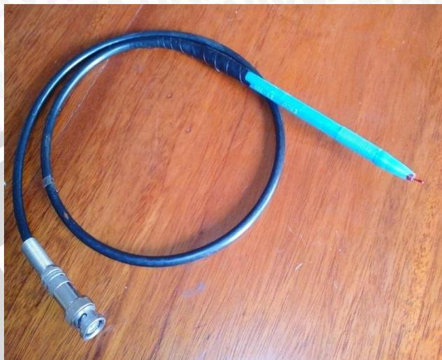
Gambar 5.2 Elektroda selektif ion Rhodamin B tipe kawat terlapis
