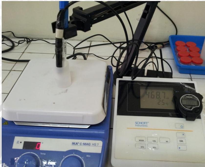
**Gambar 5.2 ESI Hg<sup>2+</sup> tipe kawat terlapis pada proses pengukuran**
