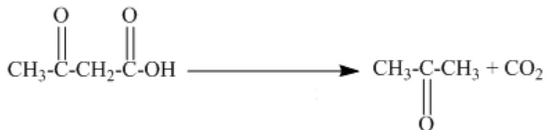
Gambar 4.11 Reaksi dekarboksilasi pada saat pirolisis
