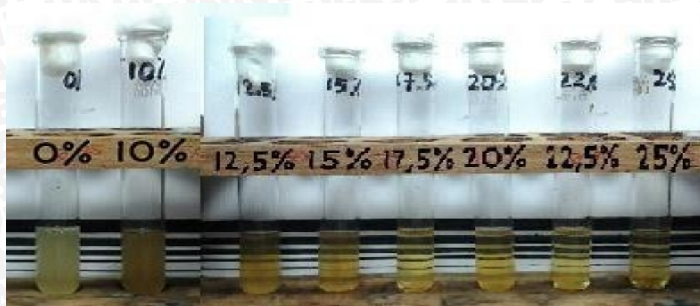
Gambar 5.3 Dilusi tabung dengan beberapa konsentrasi ekstrak daun beluntas terhadap pertumbuhan bakteri E.coli untuk uji KHM. Dengan meningkatnya konsentrasi ekstrak, pertumbuhan bakteri semakin berkurang. Hal ini tampak dari tabung yang semakin jernih, diperoleh KHM 17,5%.
