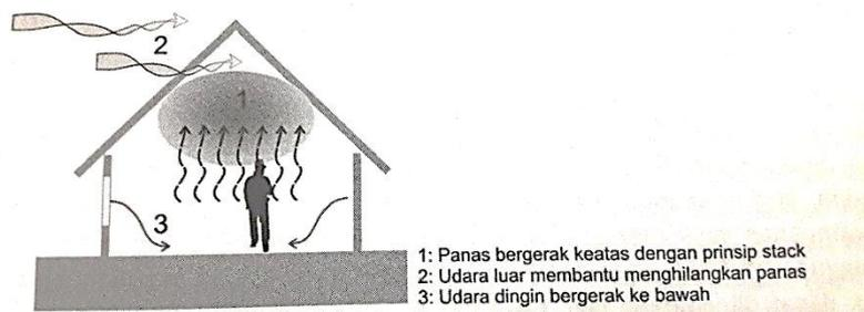
Gambar 2.4 Prinsip Pergerakan Udara Mengalirkan Panas
