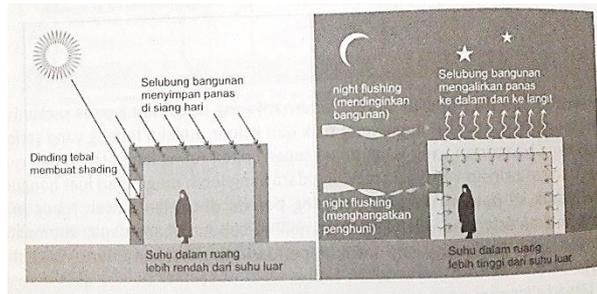
Gambar 2.9 Prinsip Ventilasi Night Flushing
