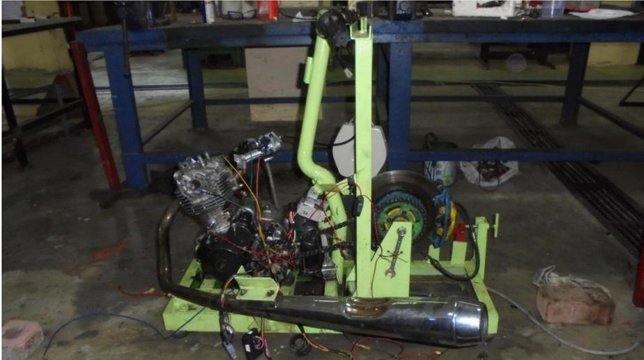
Gambar 3.1 Motor Bakar 6 Langkah
