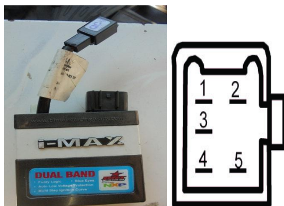
Gambar 3.8 Skema dan alat CDI-AC
