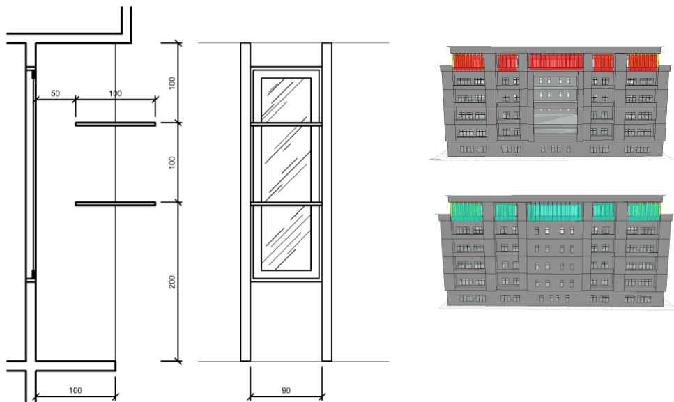
Gambar 4.44 Detail shading device D3B dan D2T pada horisontal 1
