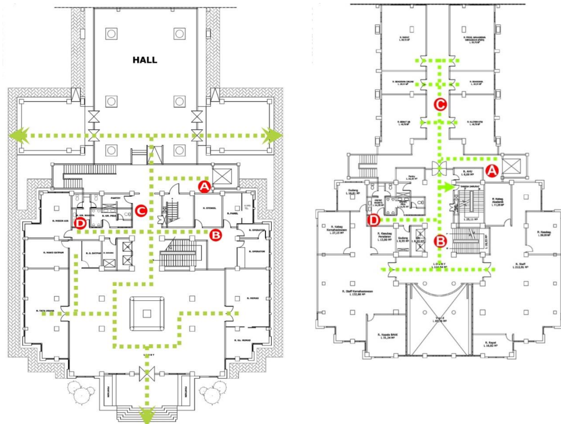
Gambar 4.46 Akses eksit koridor Gedung Rektorat
