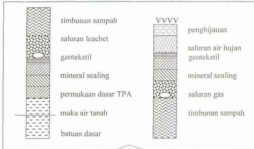
Gambar 2.2. Skema Penutup dasar (dalam GDA,1993)
