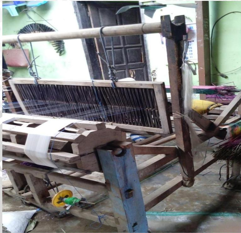
**Gambar 13** Contoh mesin tenun sederhana hasil hibah pemerintah
