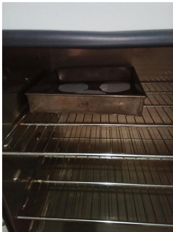
Gambar B.6 Pengeringan membran komposit hidrofobik
