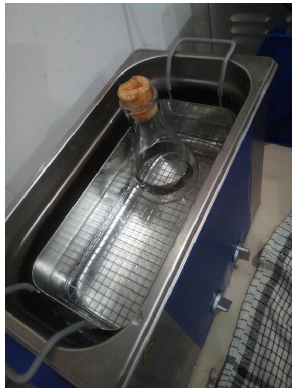
Gambar B.4 Homogenisasi menggunakan ultrasonic
