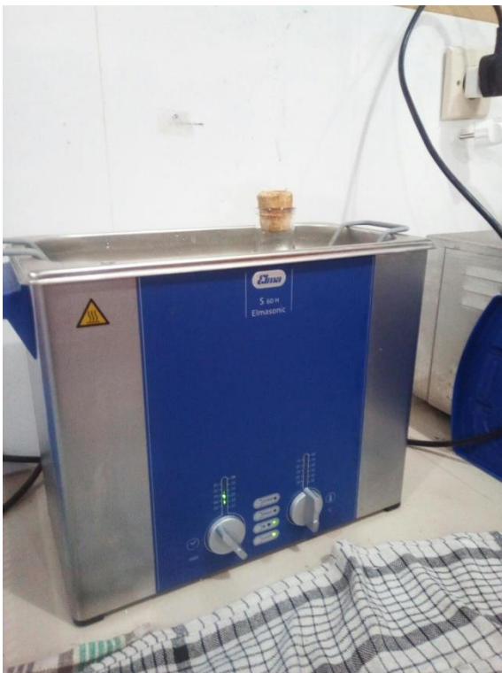
Gambar B.4 Homogenisasi menggunakan ultrasonic
