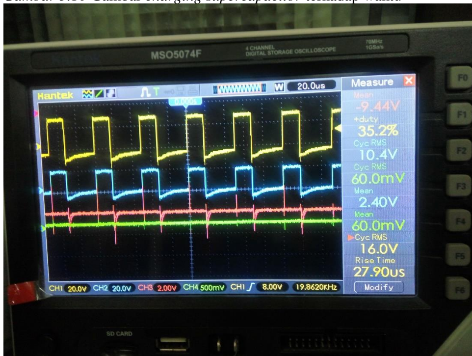
Gambar 5.11 Gambar gelombang tegangan keluaran berturut turut V_{gs} , V_{induktor} , V_{cap} , I_{ind} pada duty 35%
