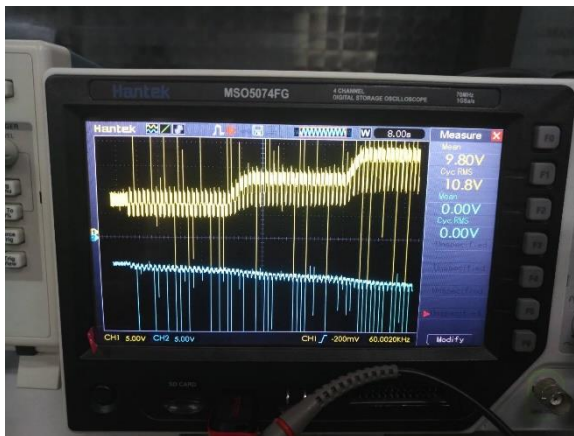
Gambar 5.27 Perubahan tegangan sumber pada set point 2 A
