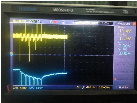
Gambar 5.26 Grafik pengujian limit tegangan kapasitor pada 19 V, dengan V_s = 10 V, set point arus 2 A
