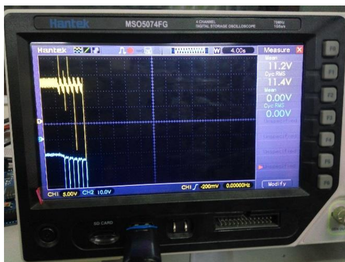
Gambar 5.25 Grafik pengujian V_c > V_s dengan V_s = 10 V, set point arus 3 A
