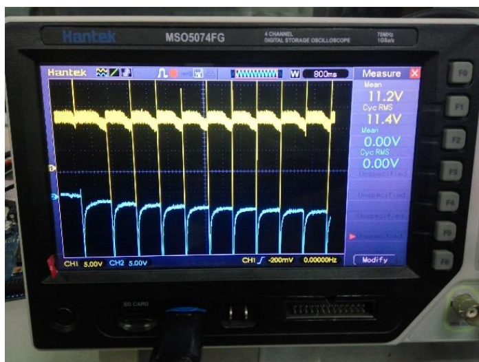
Gambar 5.24 Grafik pengujian V_s > V_c dengan V_s = 10 V, set point arus 1 A
