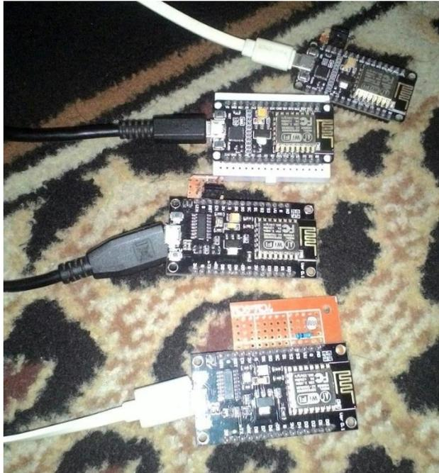
**Gambar 5. 8. NodeMCU sebagai MQTT-Client**
