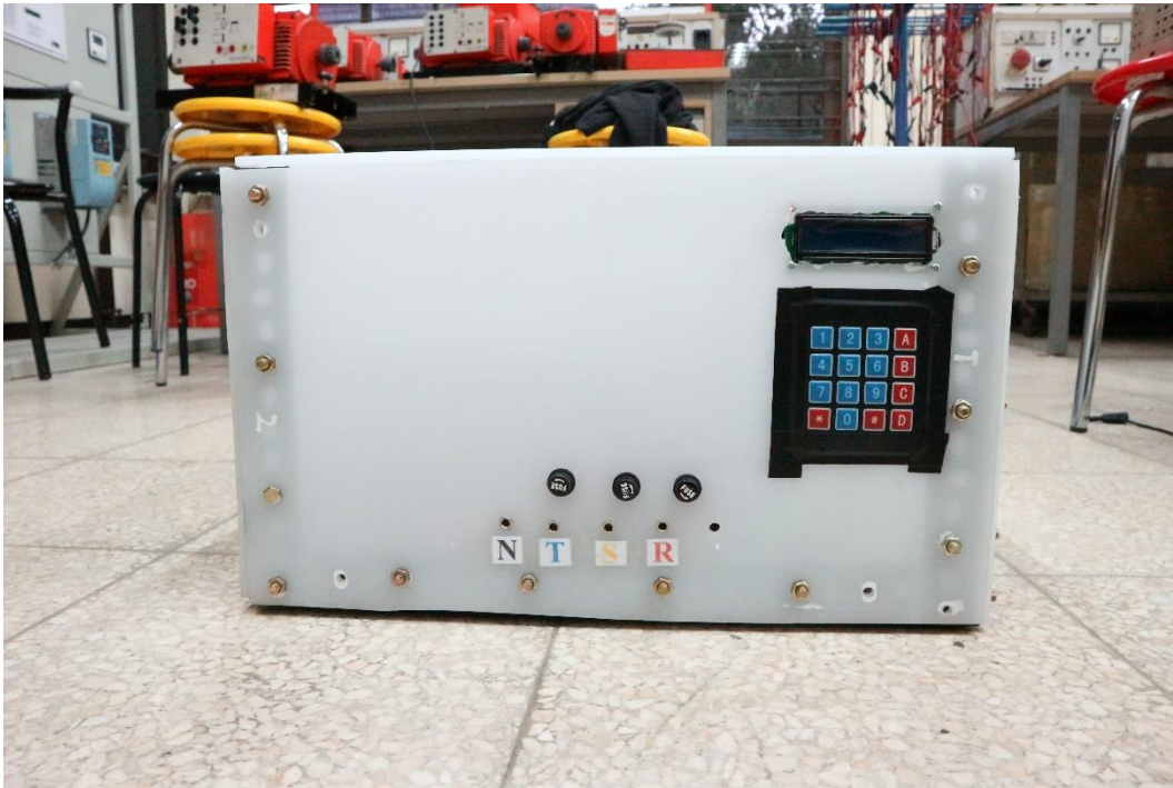
Gambar 6 Alat penurun tegangan tiga fasa yang dibuat tampak depan
