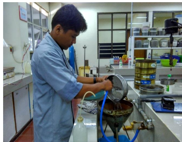
12. Pengukuran agregat metode DMR
