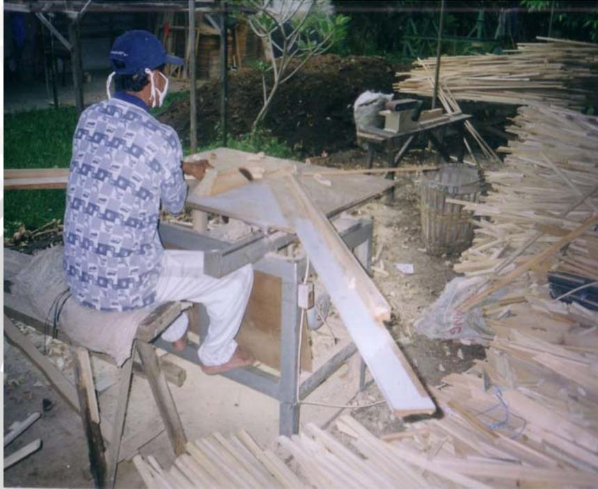
Keterangan : Gambar di atas merupakan foto pemotongan kayu sesuai dengan ukuran Figura ditempat produksi yang terpisah.
