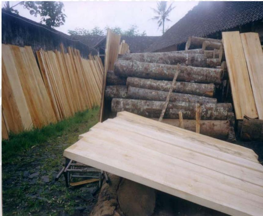
Keterangan : Gambar di atas merupakan foto penjemuran blabak yang dilakukan di tempat produksi.
