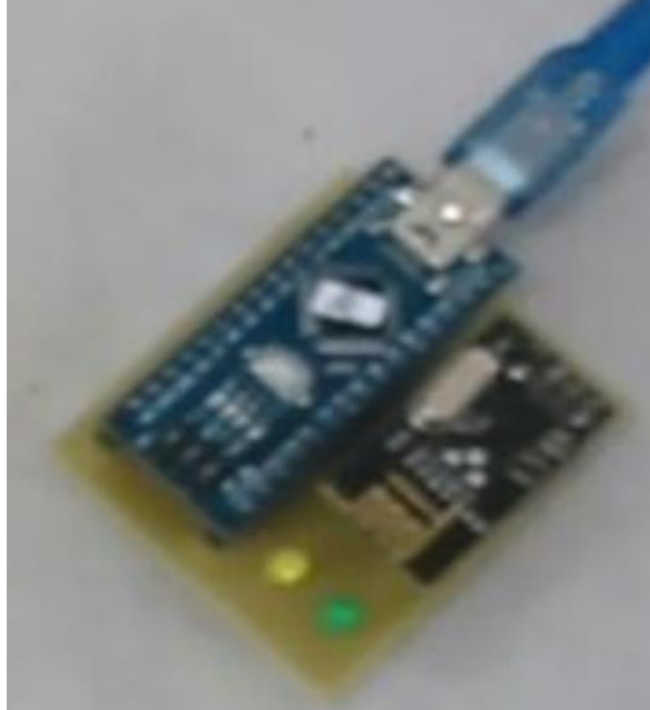
Gambar 5.9 Implementasi nRF24L01 sebagai Komunikasi Wireless
