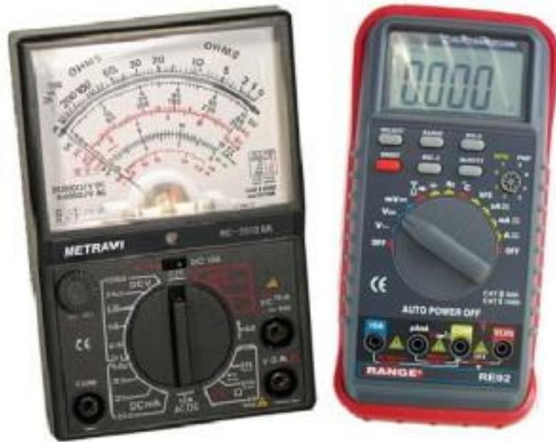
**Gambar 2. 5 Multimeter Analog dan Digital**
