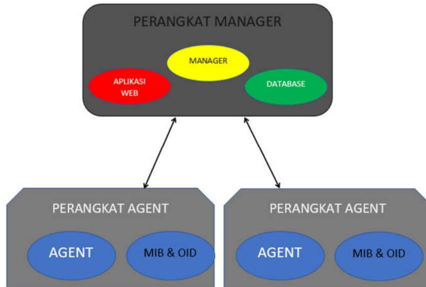
**Gambar 4.3 Perancangan Sistem *Monitoring* Perangkat IoT**
