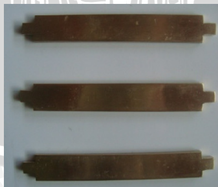
Gambar 4.3 Master model kuningan ukuran 65mm x 10mm x 2,5mm (Sumber: foto koleksi pribadi)
