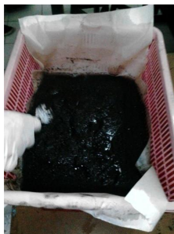
Proses penyaringan biochar asam nitrat
