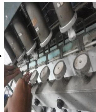
Pemasangan sampel tube goldfish dibawah kondensor
