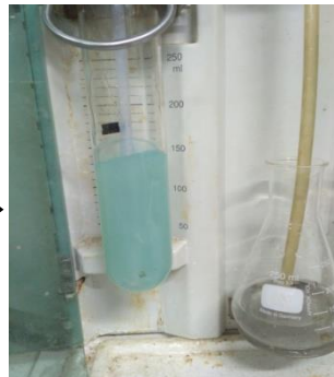
Setelah ditambah NaOH dan H 2 O disteam hingga erlenmeyer berisi 150 mL larutan
