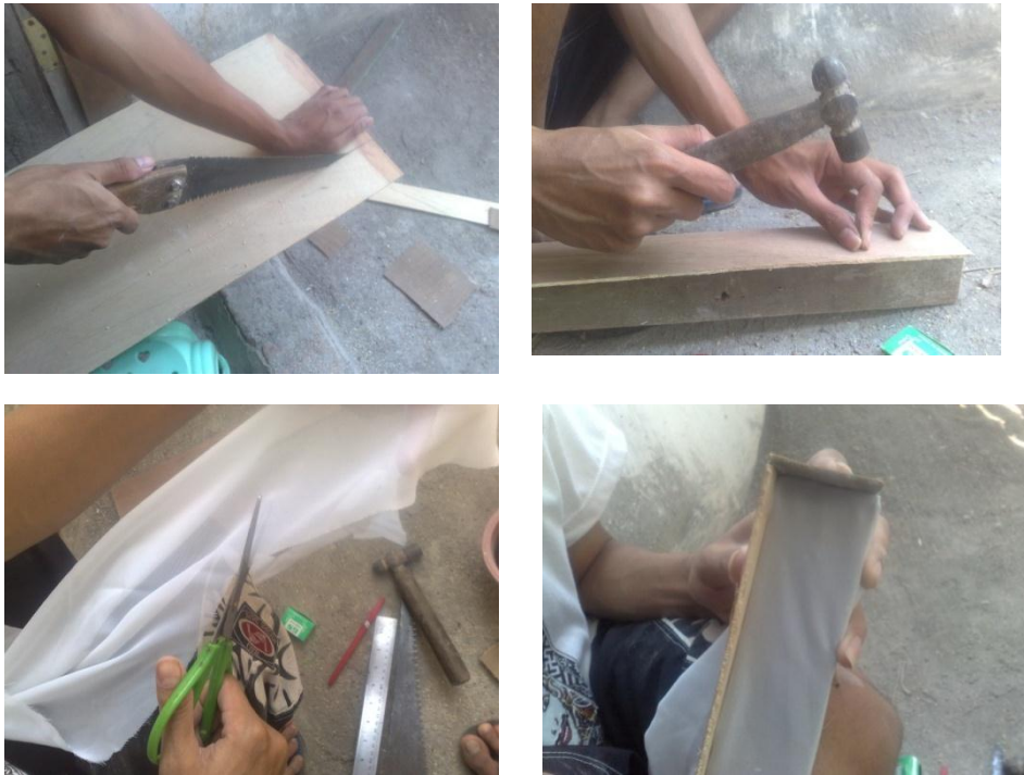
Gambar 1. Pembuatan Cetakan Pita Tanam Organik
